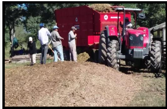
Imágenes 7 y 8. Maquina picadora de arrastre y el aoplado forrajero en plena operación de descarga del picado.
