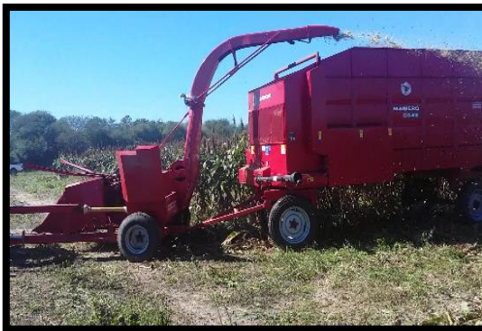
Imágenes 7 y 8. Maquina picadora de arrastre y el aoplado forrajero en plena operación de descarga del picado.
